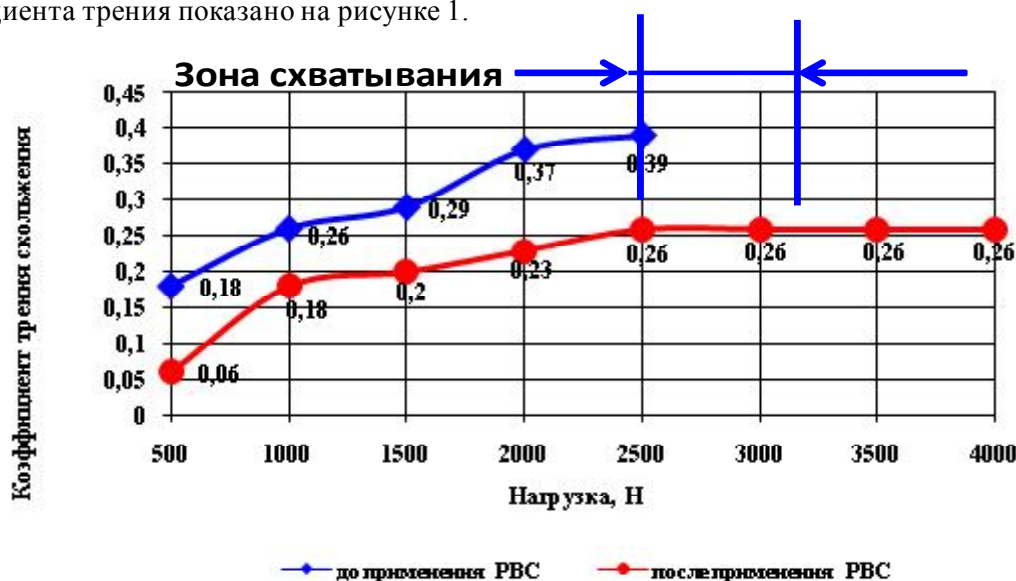
Рис. 1. Изменение коэффициента трения скольжения при использовании модификатора трения.
