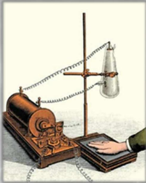
*Установка для экспериментов с X-лучами – пример простейшего рентгеновского аппарата.*
